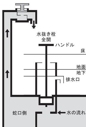
通水時は、水抜き栓のハンドルを左（反時計回り）に止まるまで回します。
