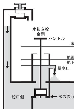
水抜きをする場合には、水抜き栓のハンドルを右（時計回り）に止まるまで回します。蛇口を開き、水道管に空気が入ることで水が抜けます。
