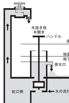
水抜き栓が半開きの状態では、水抜きができず凍結するおそれがあるほか、常に水が地下に流出し、水道料金が高額になる場合があります。
